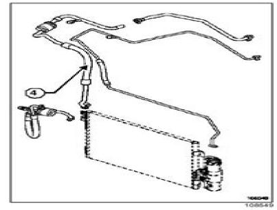
Demontaţi conducta compresor - conductă intermediară (4).
