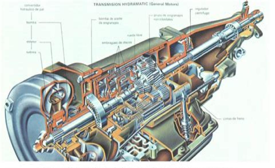
Funcionamiento de la transmisión automática
