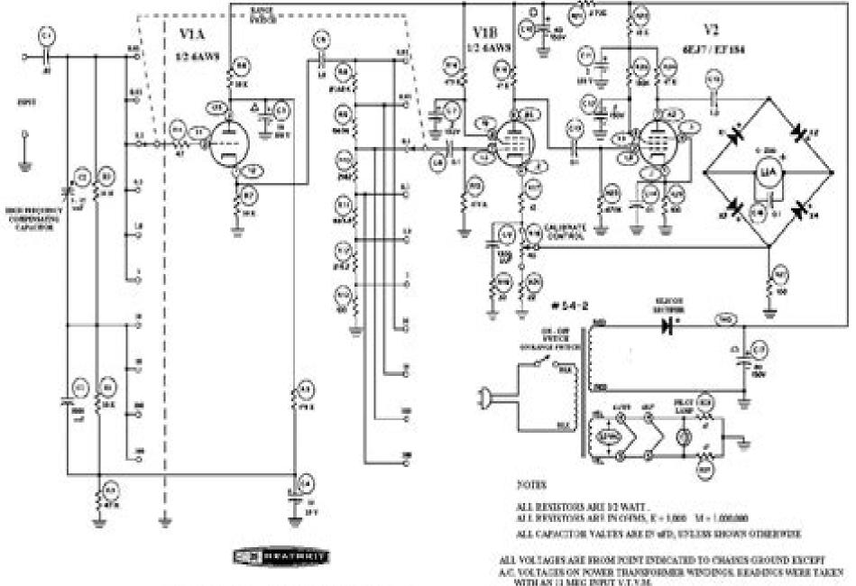
AC VACUUM TUBE VOLTMETER MODEL IM - 21
