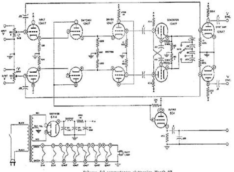
Schema del commutatore elettronico Heath 83,
