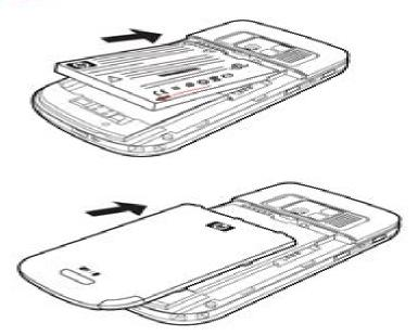
Untuk memasang baterai dan memasang kembali penutup baterai:
